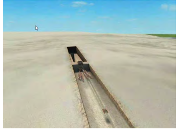
Aire de traction pour réarmement contrepoids au premier plan, tranchée au second.
