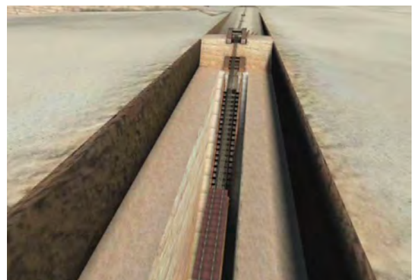
Le contrepoids est à mi-parcours dans la tranchée creusée dans le socle rocheux
