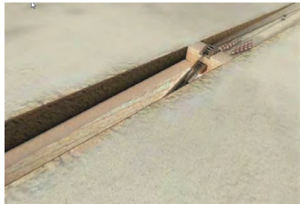
Tranchée contrepoids à gauche, aire de traction pour réarmement contrepoids à droite
